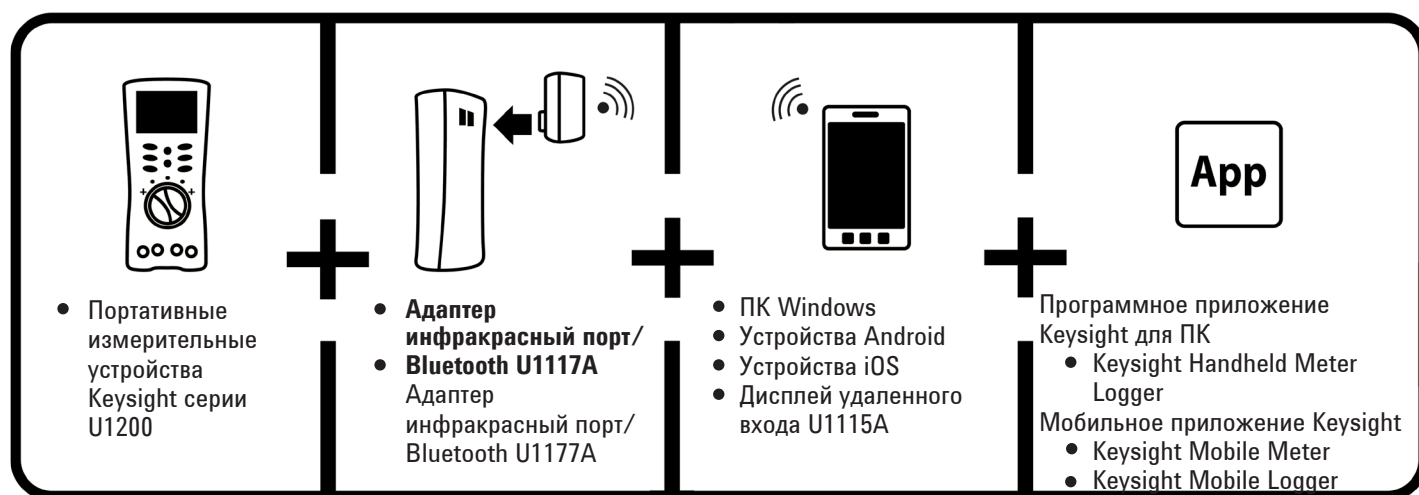
Рис. 1. Решение установки беспроводного удаленного соединения Keysight
